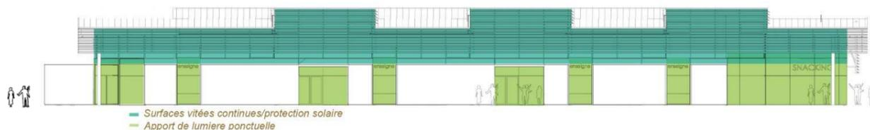
90% du rayonnement solaire est géré par les protections solaires extérieures, les 10% restant pouvant être gérés ponctuellement à l'aide de stores mobiles intérieurs au besoin.
