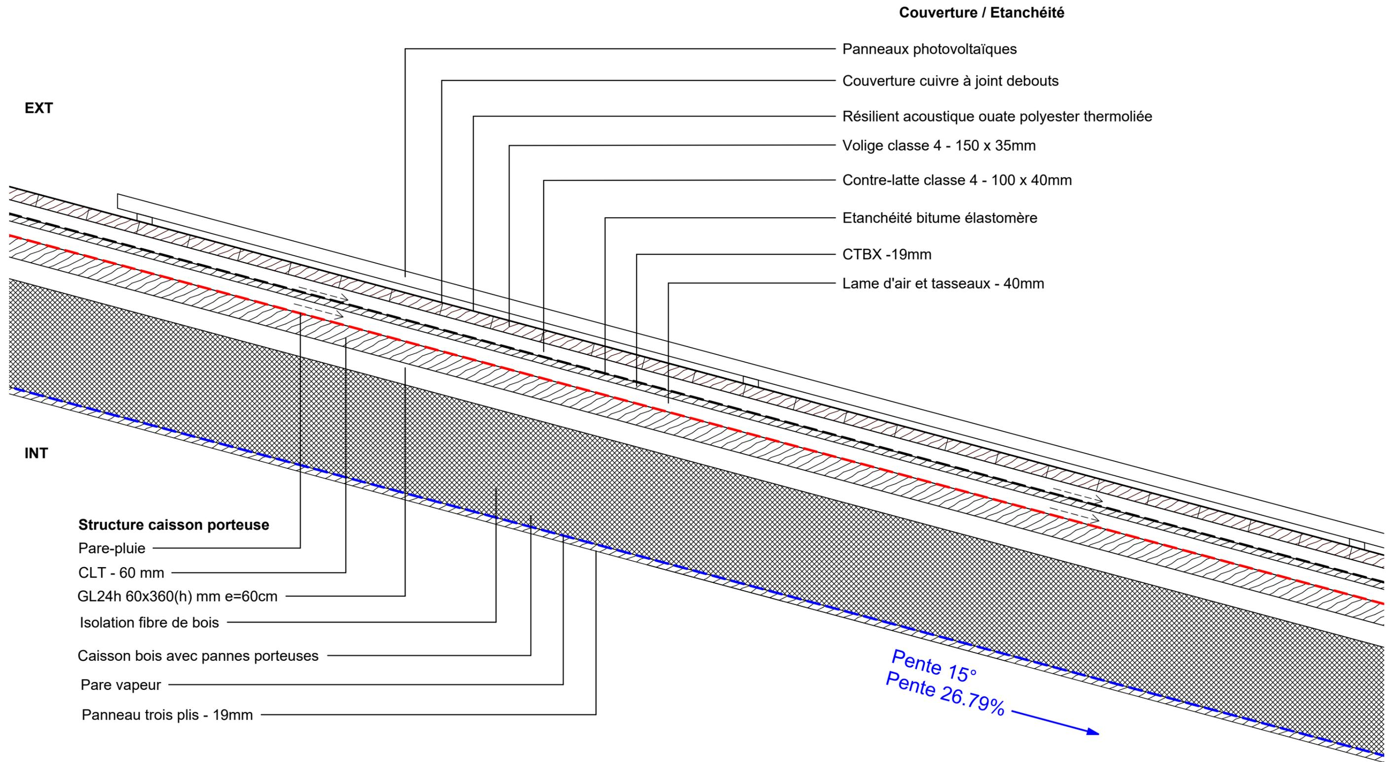
Coupe type verticale de la toiture en caisson bois - échelle 1:10
