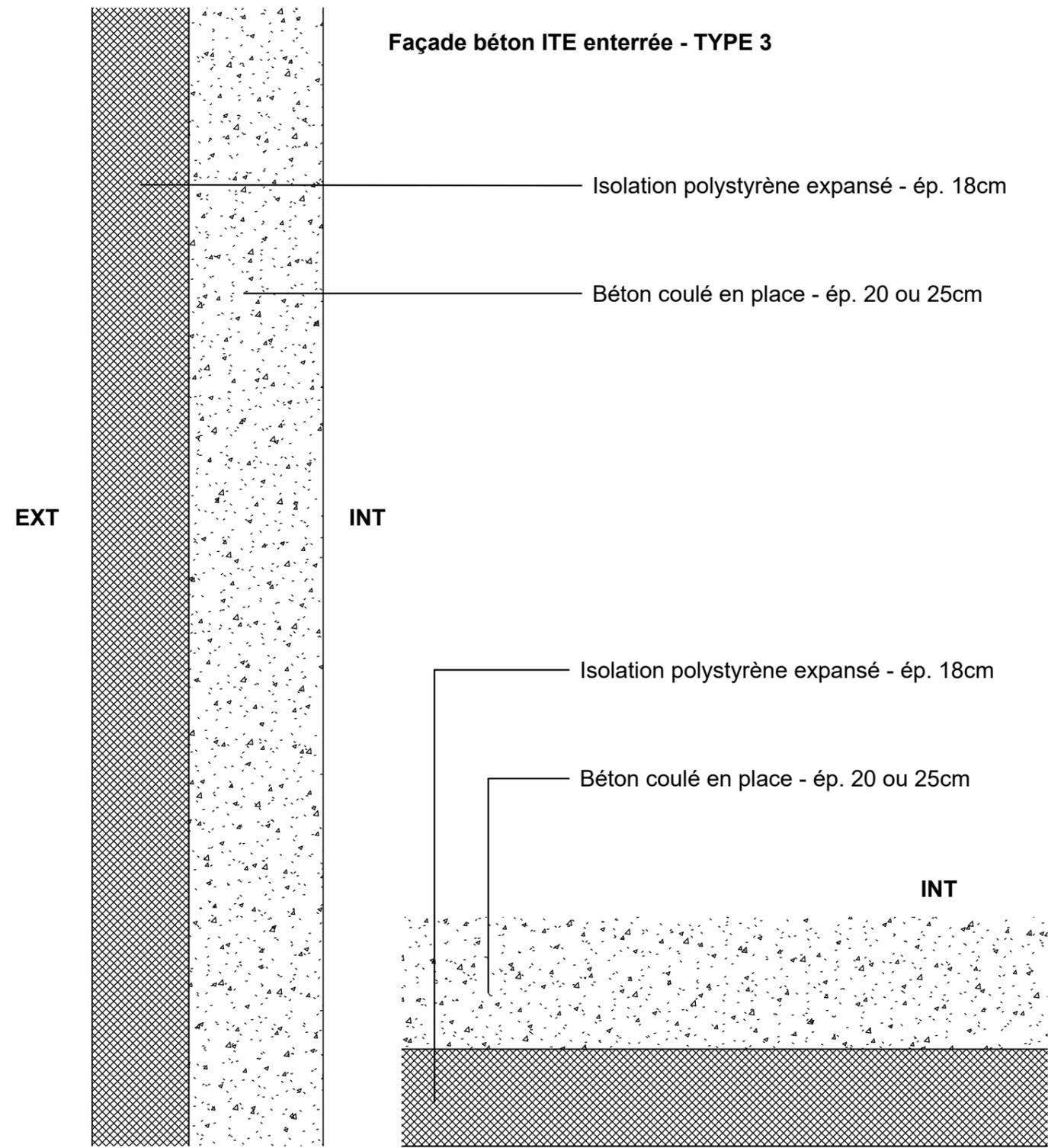
**Façade béton ITE enterrée - TYPE 3**
