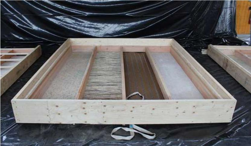
TESTS DE FONDS DE COFFRAGE : OSB perforé /Canisse de roseau/Lattis métallique/
