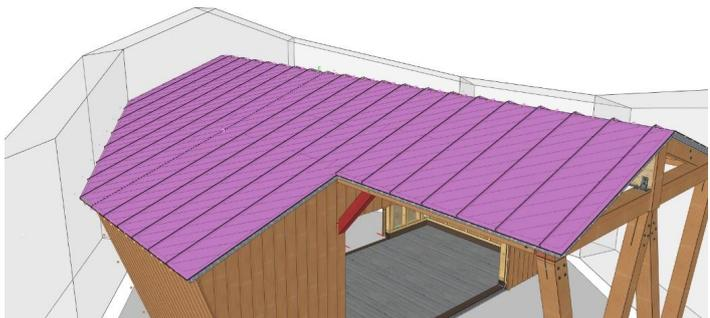
Dépose des profils en rives et en égouts et de l'ensemble des pattes de fixations associées
