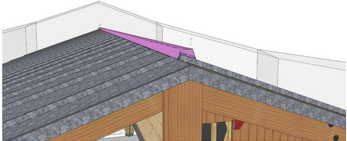
Dépose des bacs à joints debout et de l'ensemble des pattes de fixations associées
