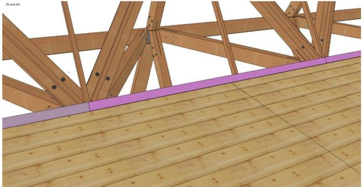
Dépose des lattages support de relevé et de bardage haut
