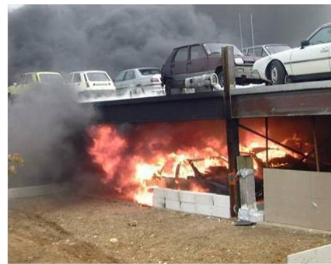
Figure 5-1 : Essai de feu réel de véhicules légers - CTICM/EFECTIS France
