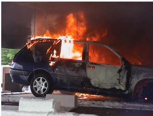
Figure 5-1 : Essai de feu réel de véhicules légers - CTICM/EFFECTIS France
