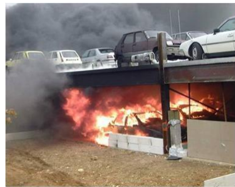
Figure 5-1 : Essai de feu réel de véhicules légers - CTICM/EFFECTIS France
