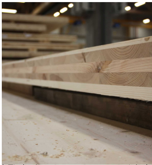
Les planchers en CLT (Cross Laminated Timber) assurent une compacité du système constructif pour contenir la hauteur du bâtiment
