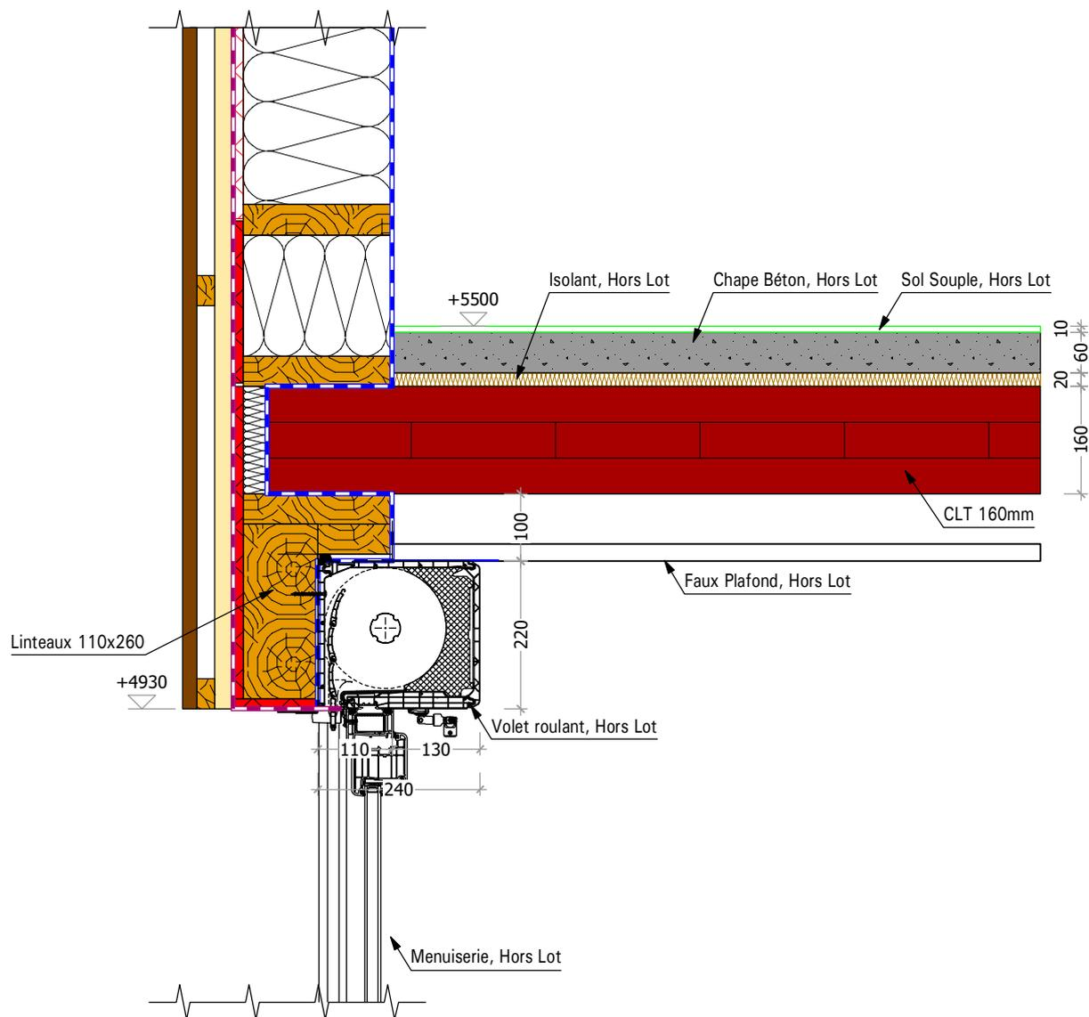
Detail N° 25      Détail Linteau 110x260 MoB R + 1, avec volet roulant
