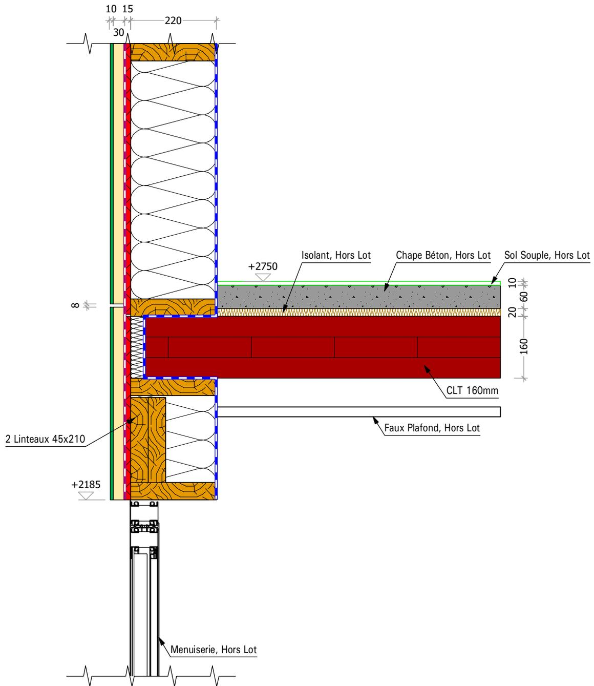
Detail N° 15 Détail Linteau 2x45x210 MoB RdC, sans volet roulant -
