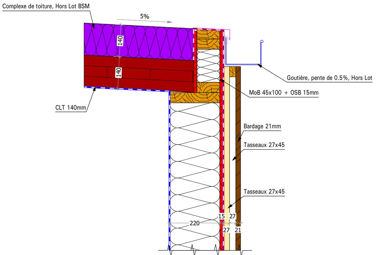
Detail N° 11 Détail Chéneaux toiture R + 3
