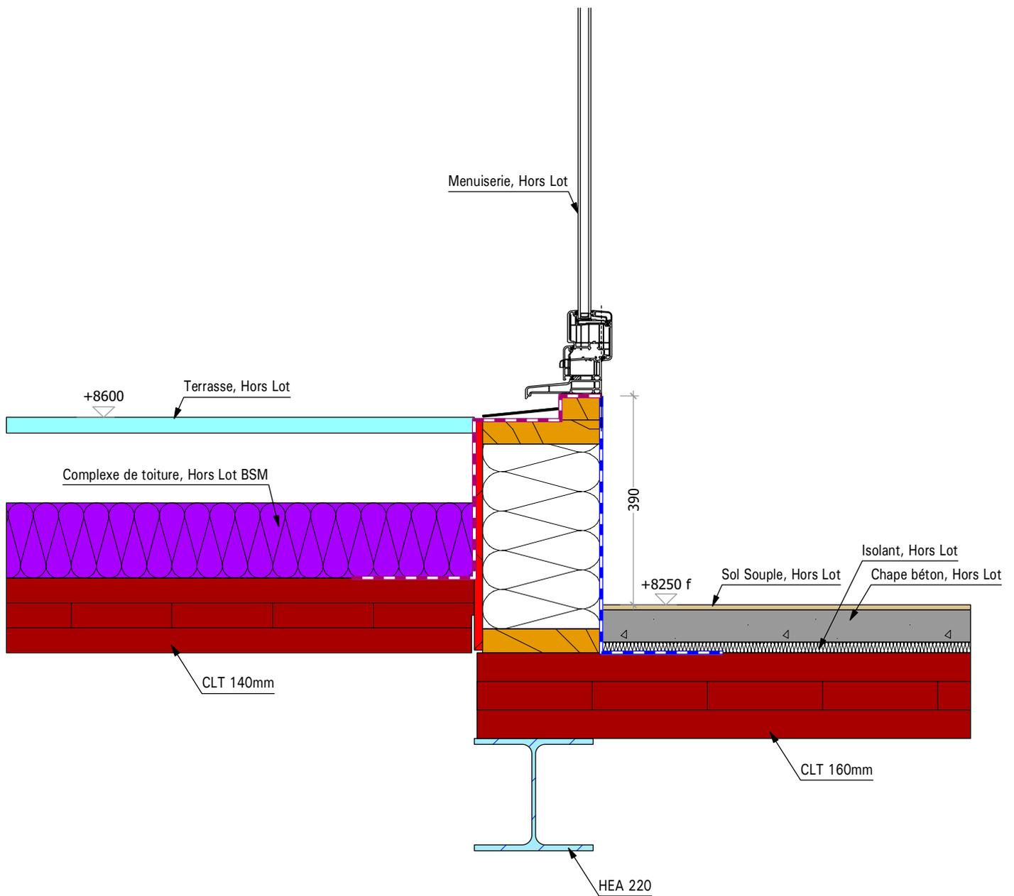
Detail N° 09      Jonction plancher CLT R+3/Terrasse R+3
