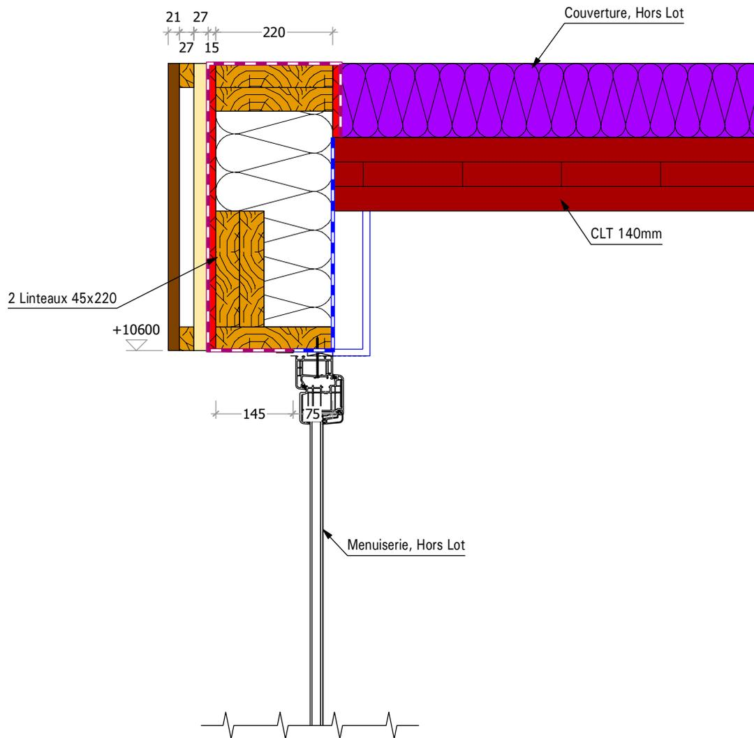
Detail N° 32      Détail Linteaux 2x45x220 MoB R + 3, sans volet roulant
