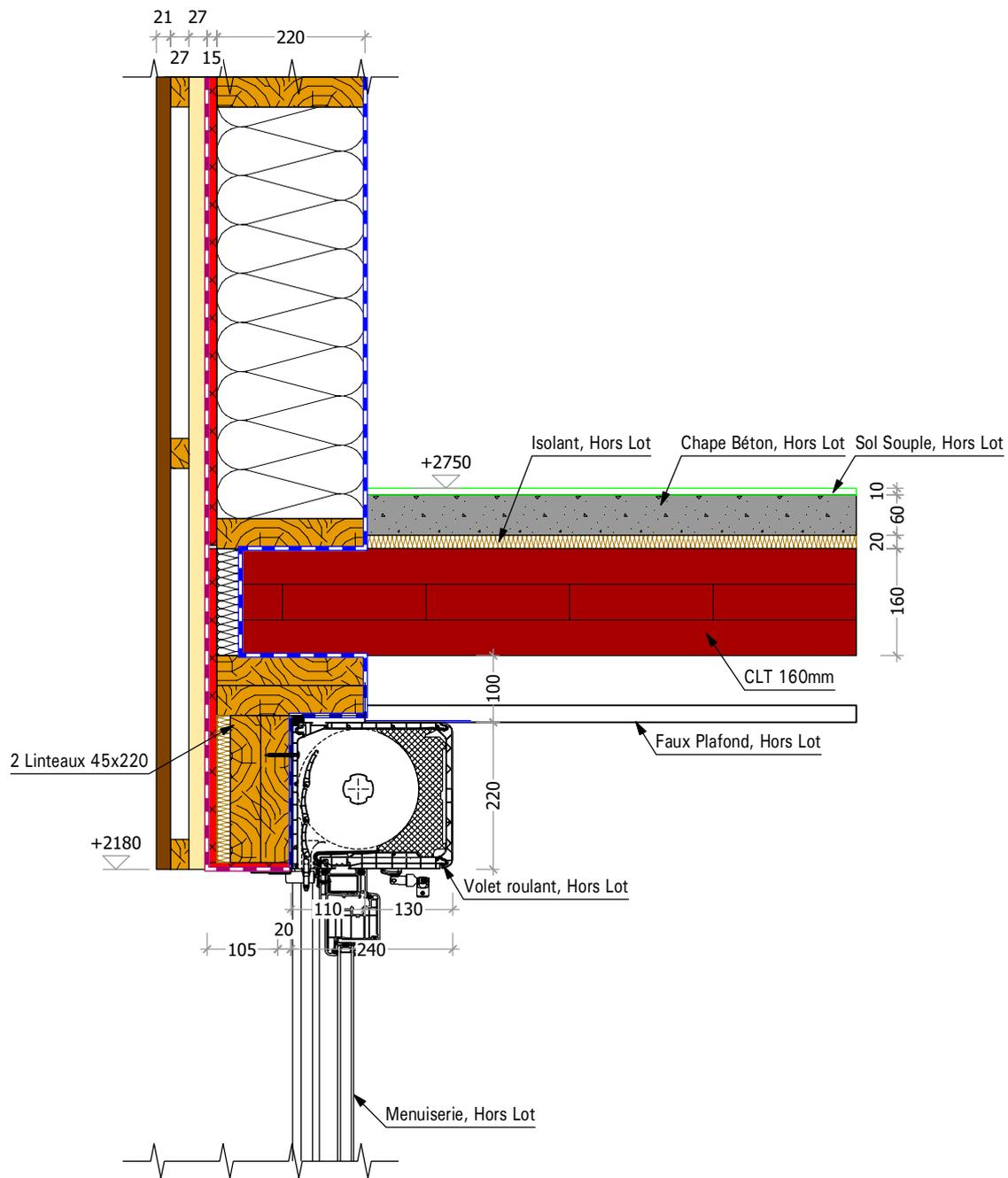
Detail N° 19      Détail Linteau 2x45x220 MoB RdC, avec volet roulant
