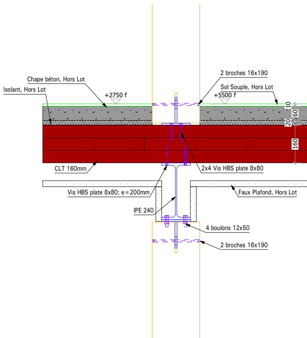
Detail N° 07      Détail appuis intermédiaire CLT planchers R+1 et R+2
