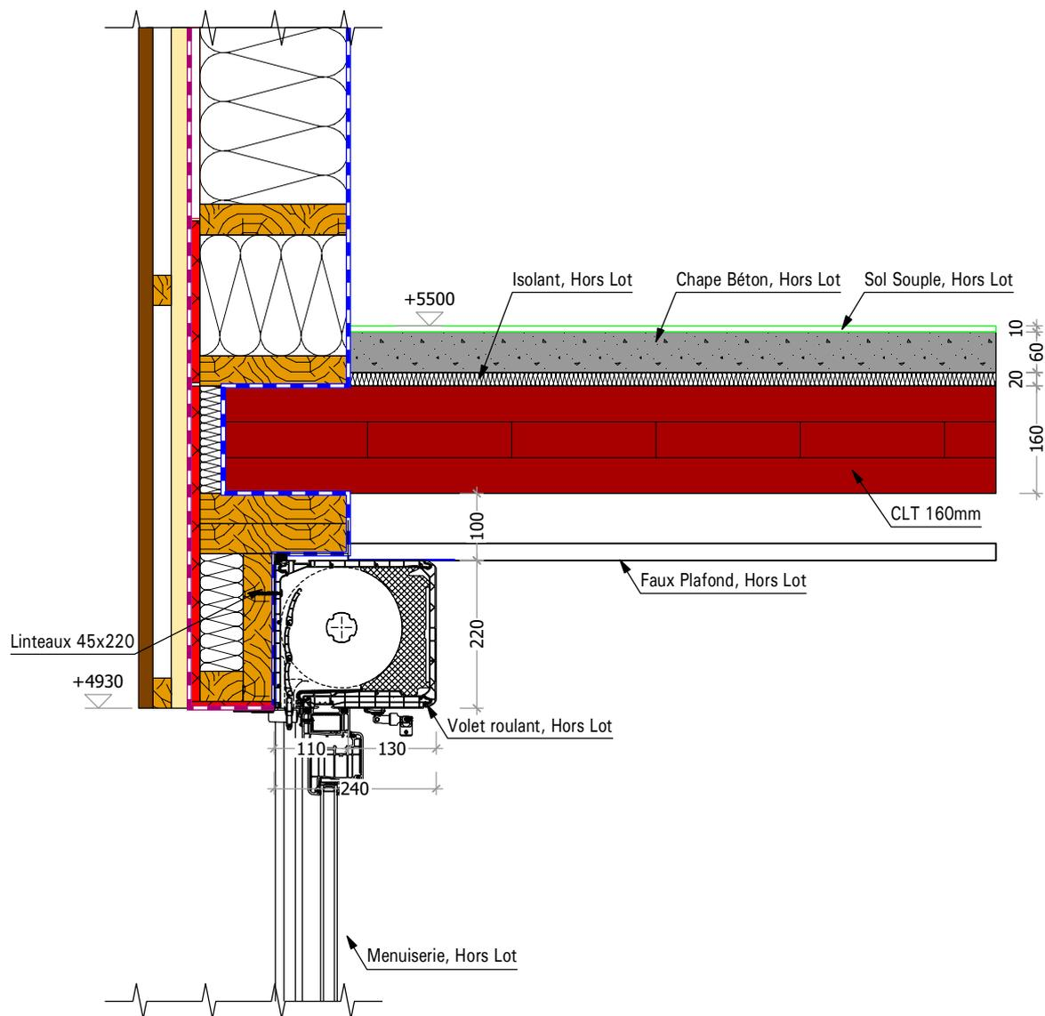
Detail N° 23      Détail Lintheau 45x220 MoB R + 1, avec volet roulant
