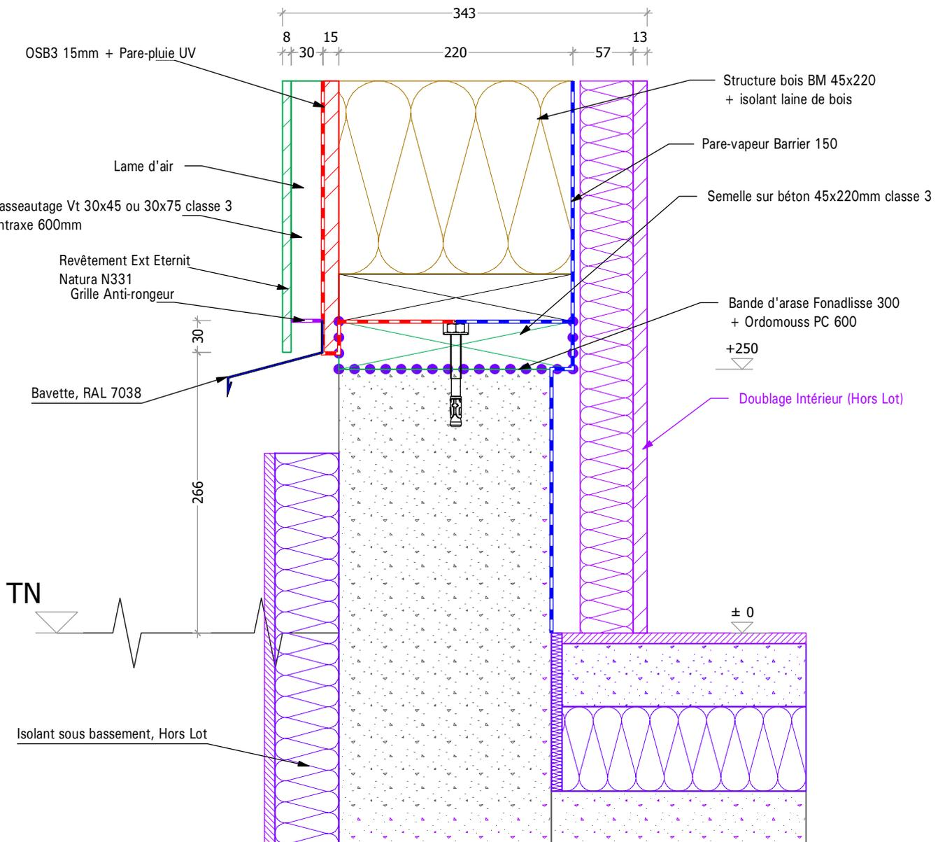
Detail N° 03      Détail pied d'ossature, partie Hall d'entrée
