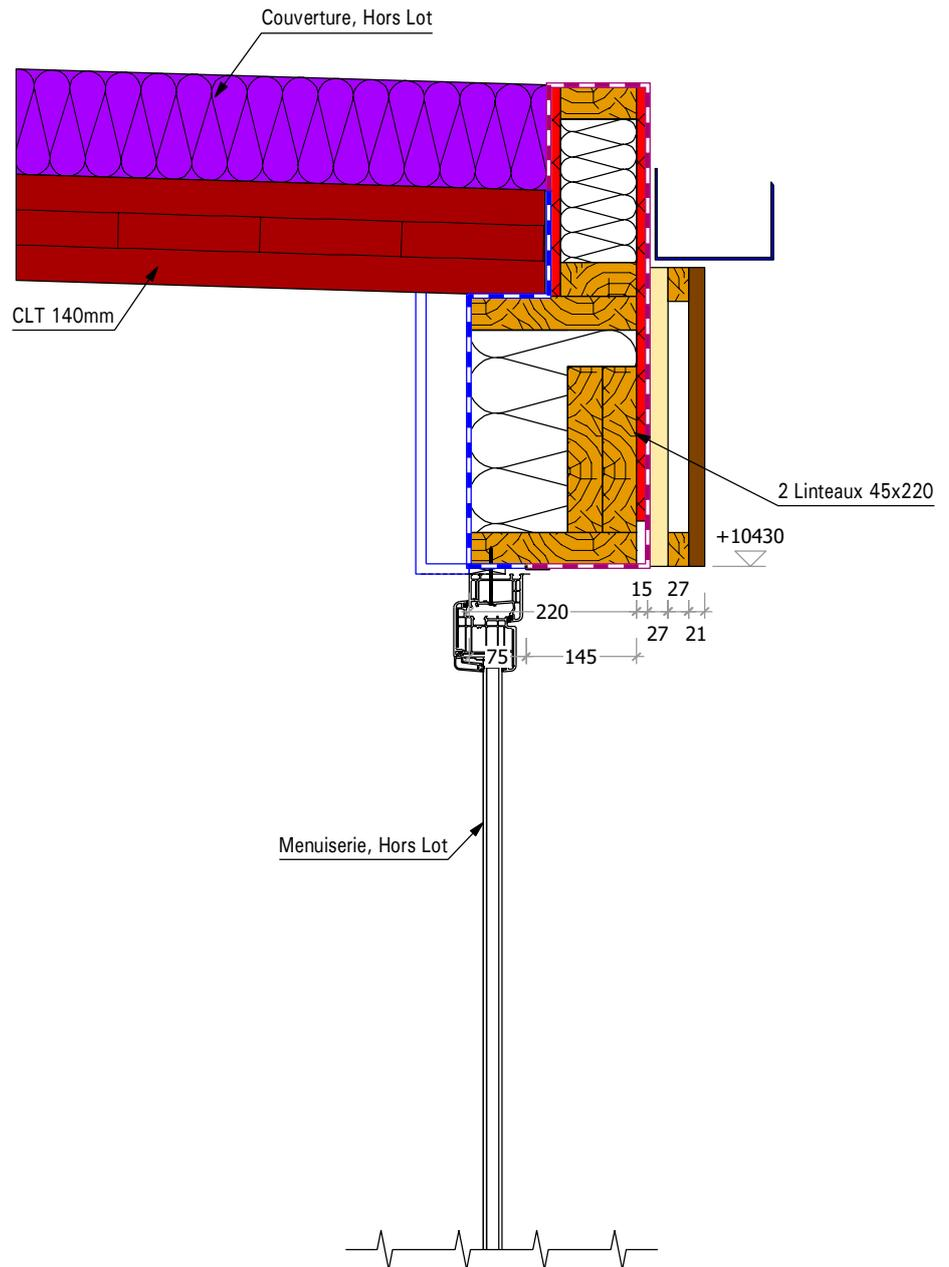
Detail N° 33      Détail Linteaux 2x45x220 MoB R + 3, sans volet roulant
