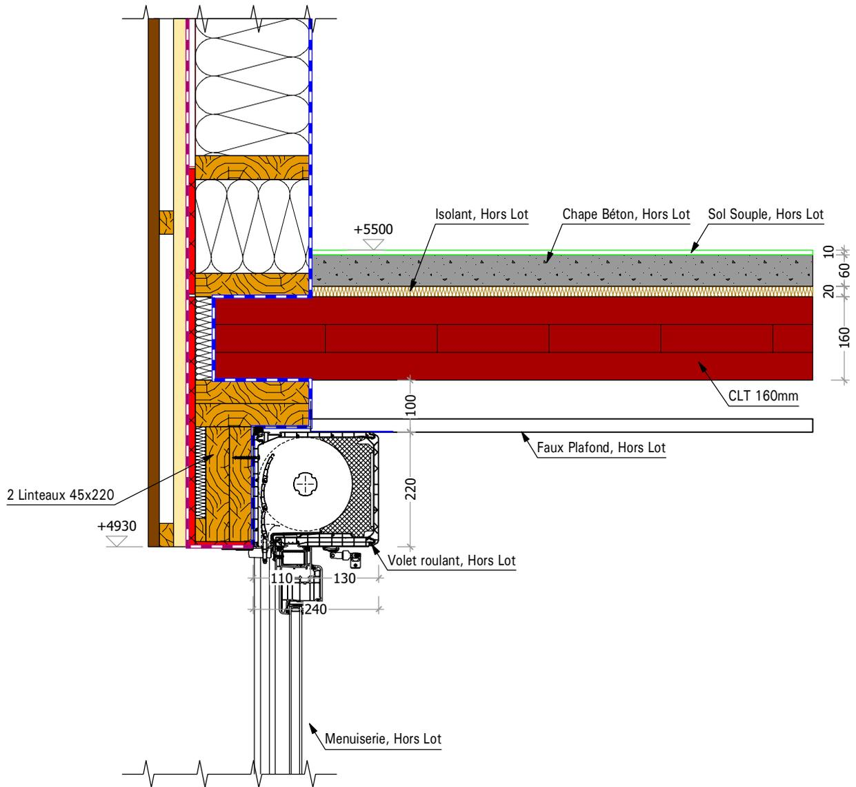
Detail N° 24      Détail Linteau 2x45x220 MoB R+1, avec volet roulant
