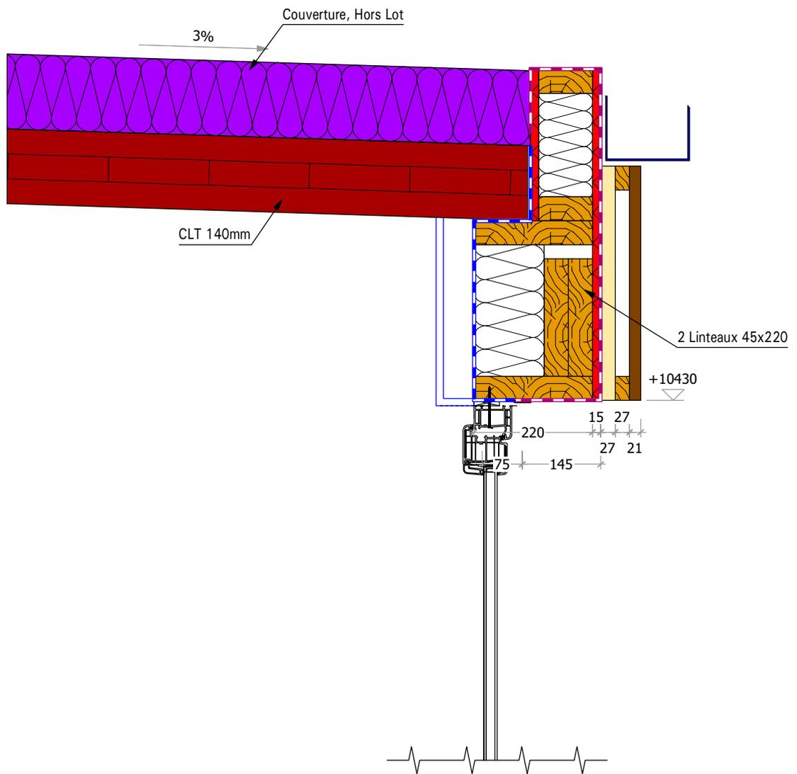
Detail N° 34      Détail Linteaux 2x45x220 MoB R + 3, sans volet roulant
