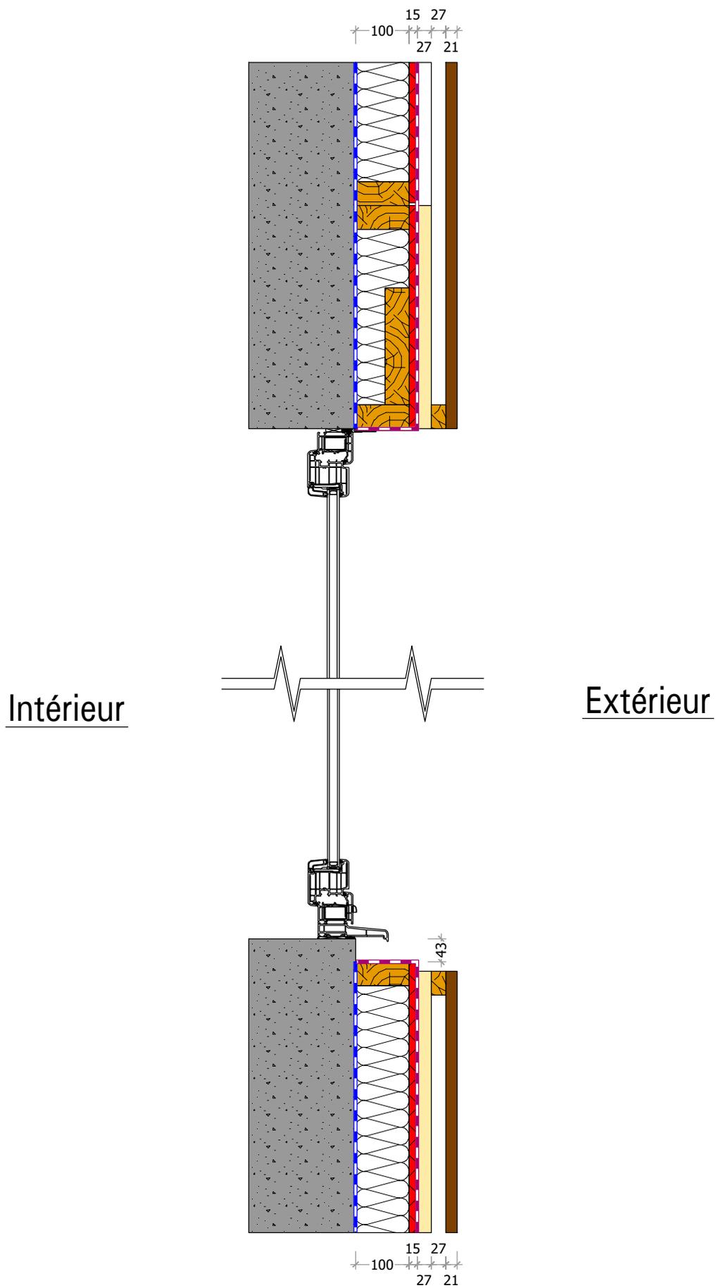
Detail N° 42      Coupe verticale sur Menuiserie Cage Béton
