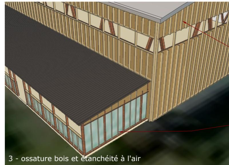
3 - ossature bois et étanchéité à l'air
