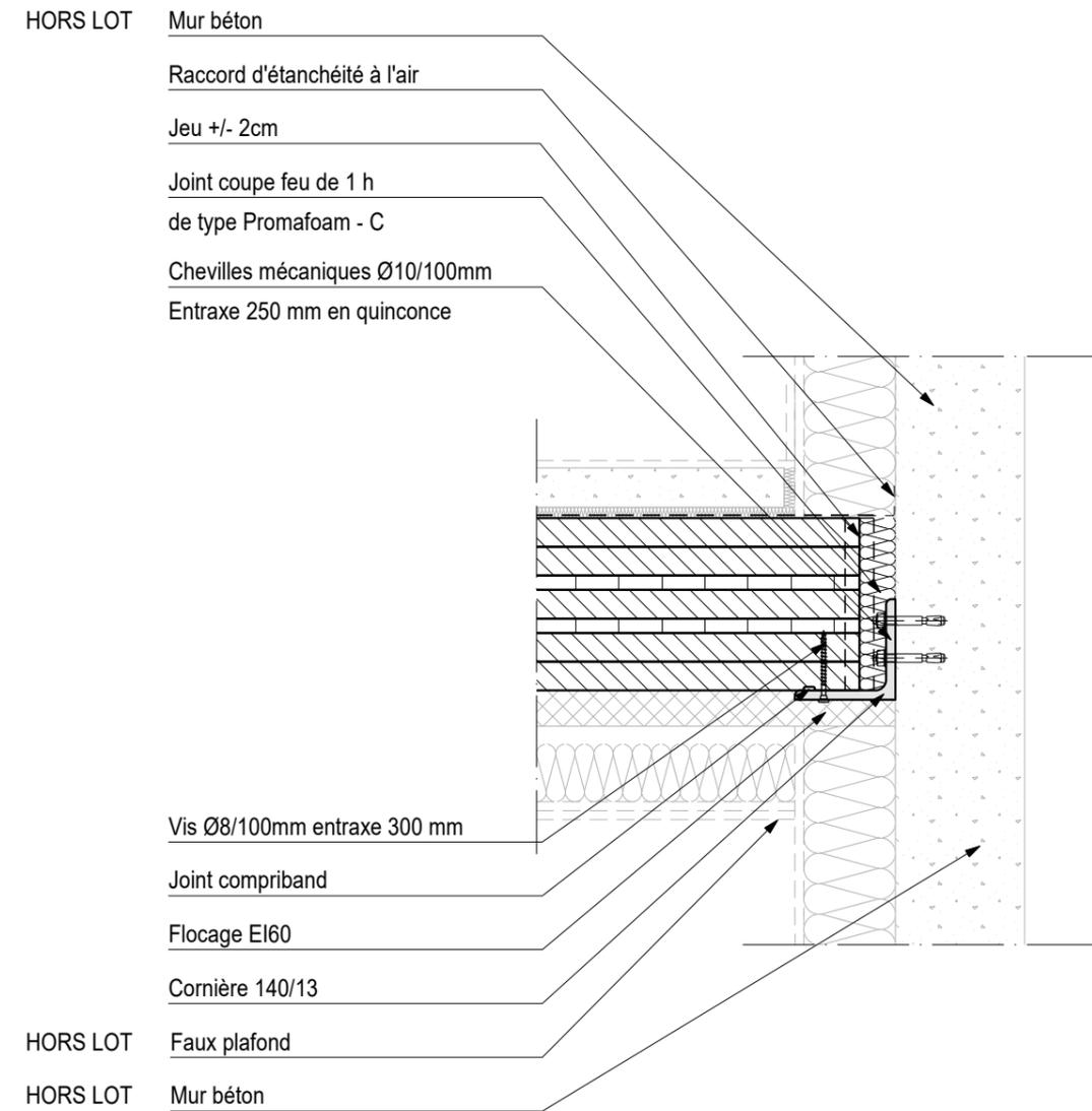
NOTA : La fixation sur béton est à adapter en fonction de la nature du mur (mur banché, mur préfabriqué, bloc à bancher...)
