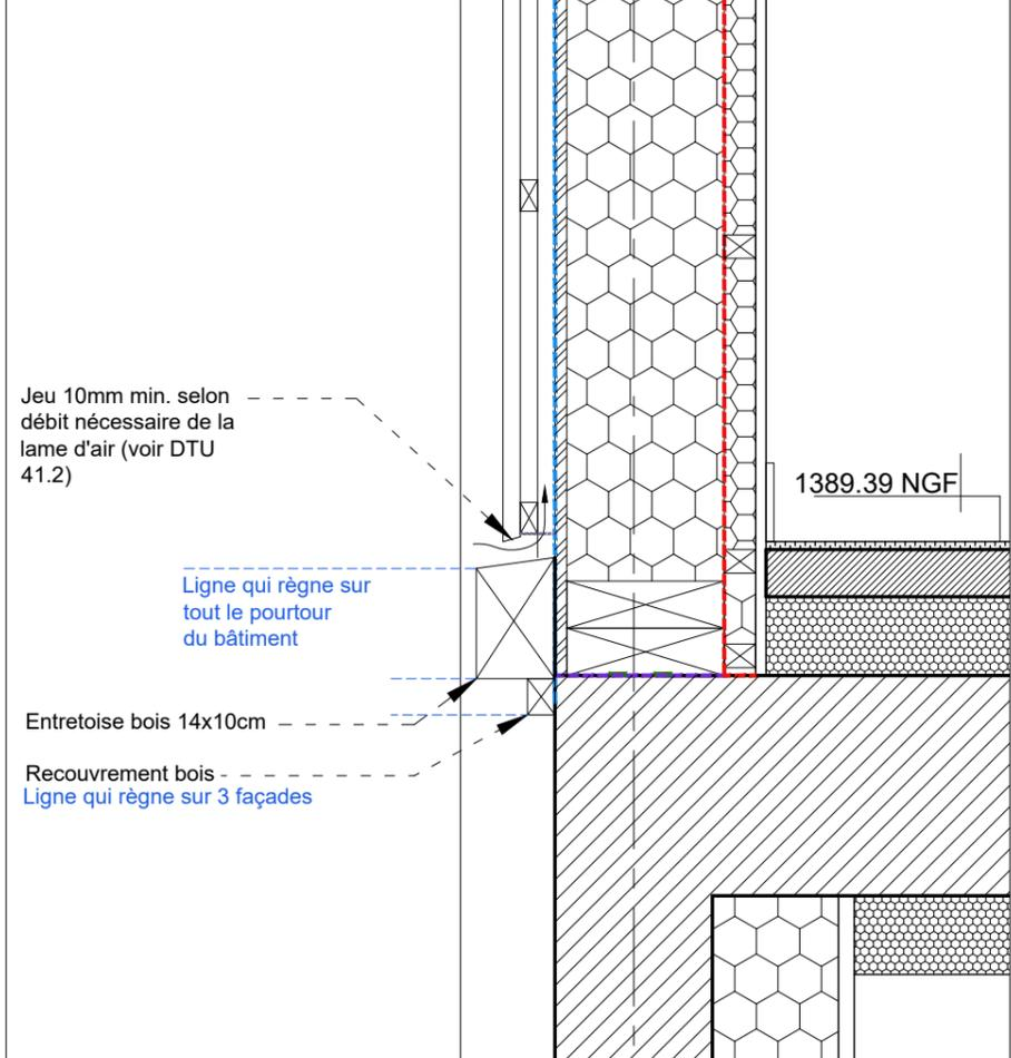
DT03b - Jonction Mur béton/Façade bois - 1/10
