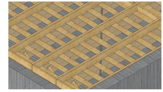
Ajout de planches 18x160 tout les 20cm entre les arbas et les recharges au fur et à mesure de la pose de l'isolant pour pose en sécurité
