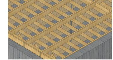
Ajout de planches 18x160 tout les 20cm entre les arbas et les recharges au fur et à mesure de la pose de l'isolant pour pose en sécurité
