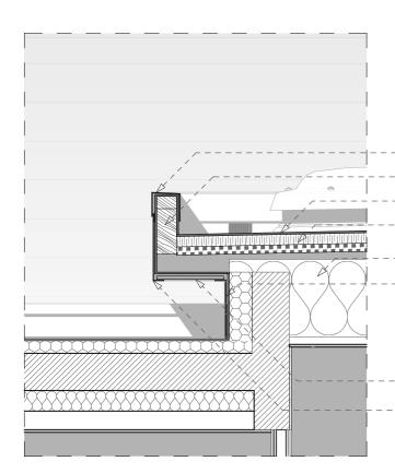
couvertine alu gris anthracite ossature relevé d'acrotère Etanchéité membrane isolation rigide
