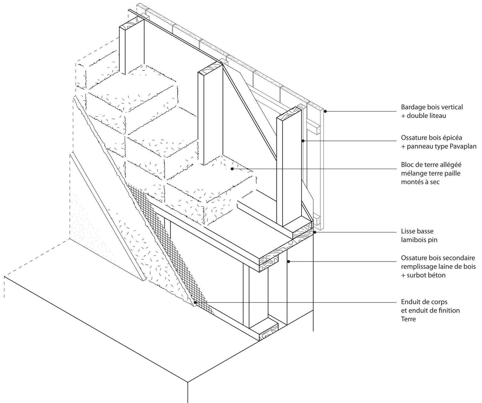
**MAS - détail de composition de des murs ossature bois , remplissage terre allégée, enduit terre intérieur.**
