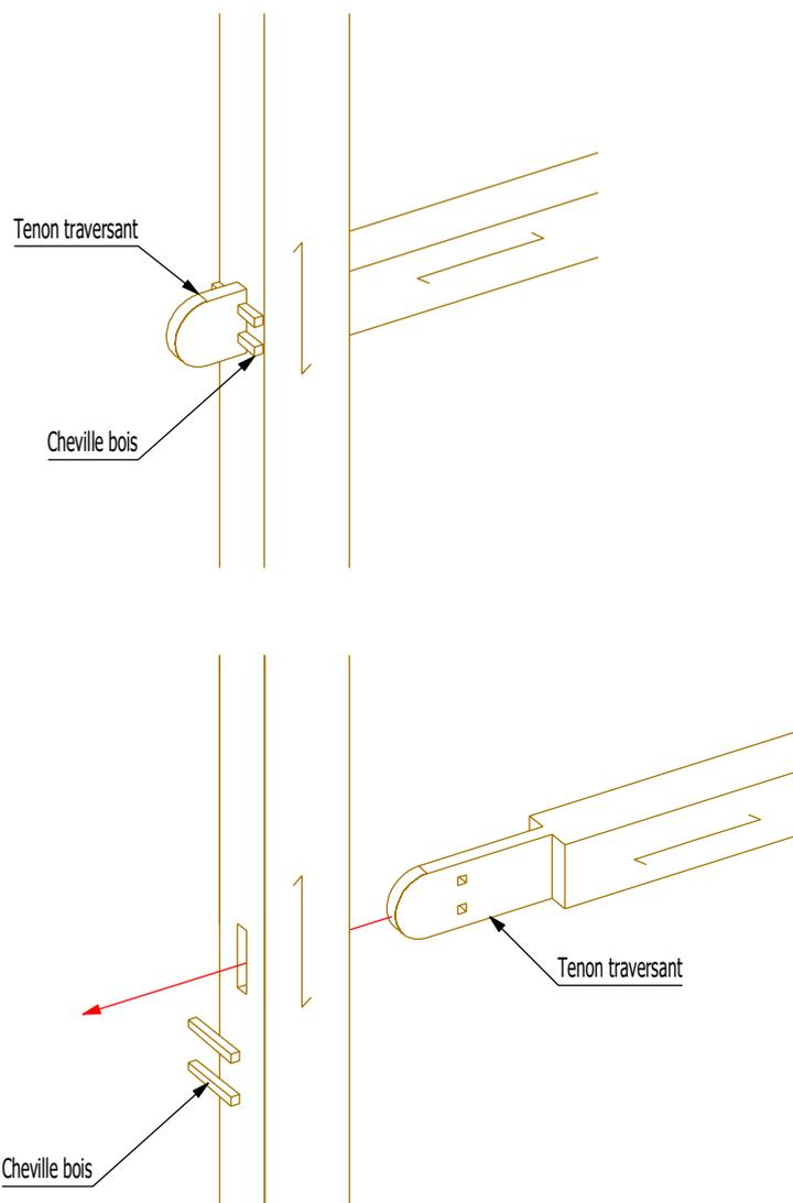
Détail n°34 - Principe d'assemblage - tenon traversant
