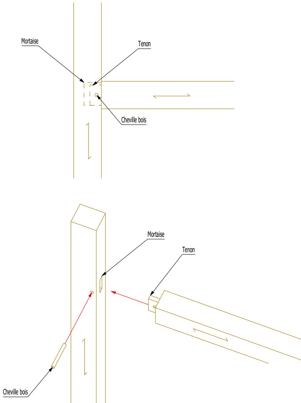
Détail n°33 - Principe d'assemblage - tenon
