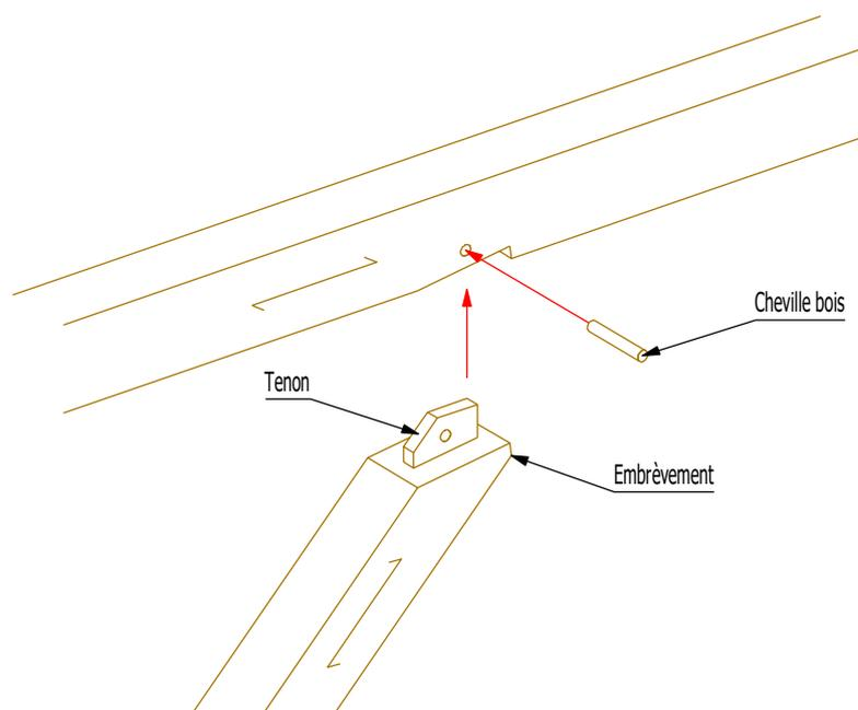
Détail n°32 - Principe d'assemblage - embrèvement + tenon
