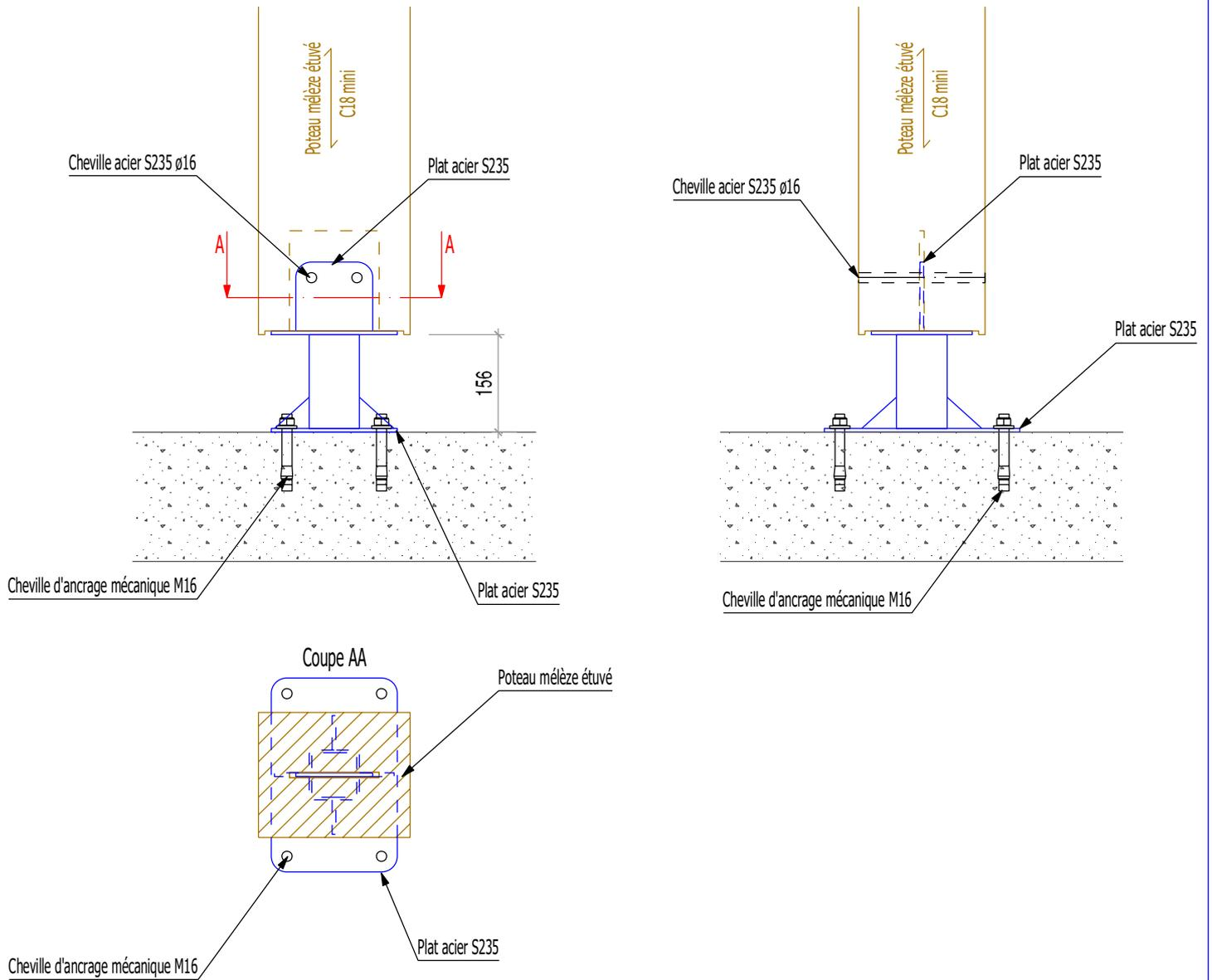
Détail n°36 - Principe d'assemblage - pied de poteau extérieur
