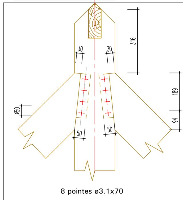
Principe de fixation des pannes et échantignoles
