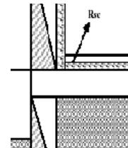
**Liaison plancher intermédiaire / mur extérieur parpaing ITI :**
