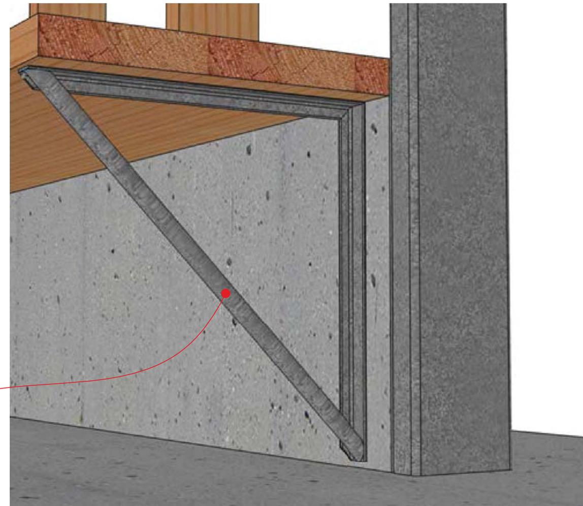
Système de fixation banc filant (Préau) :
