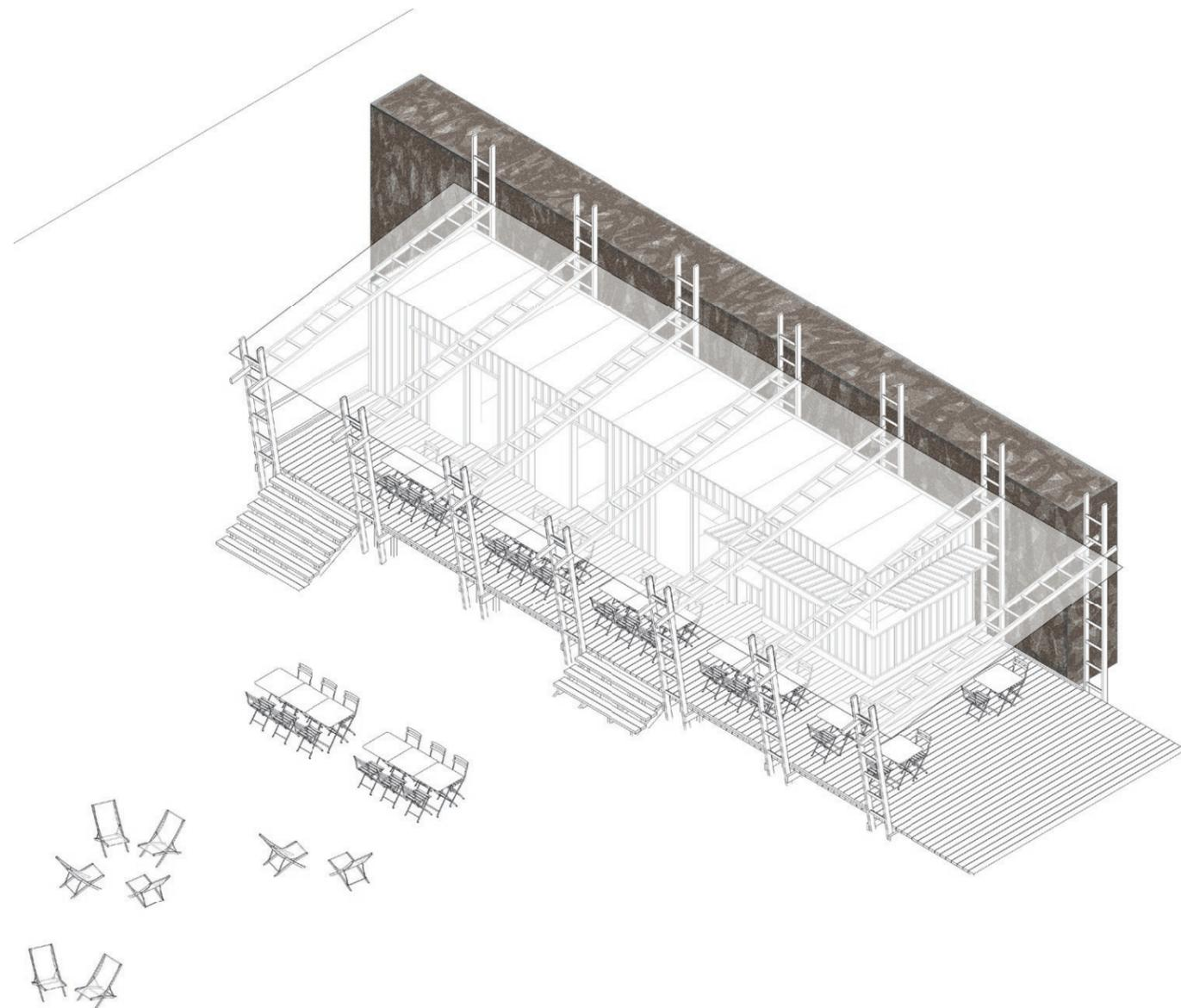
La toiture ; un grand pan incliné sur la structure, en tôle ondulée galvanisée
