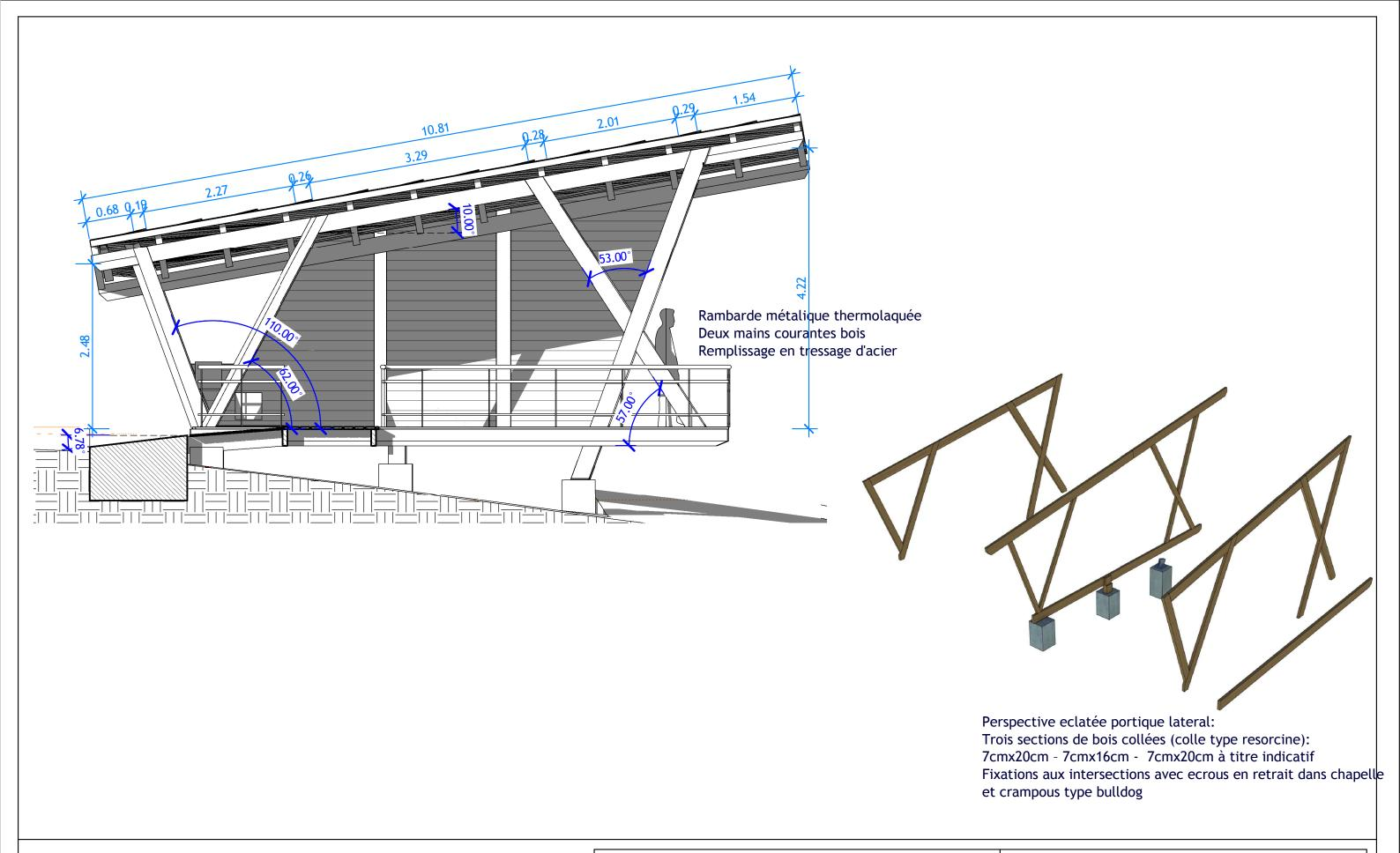
Ces plans ne sont pas des plans d'execution Les sections sont données à tire indicatif et devront être validées par le calcul
