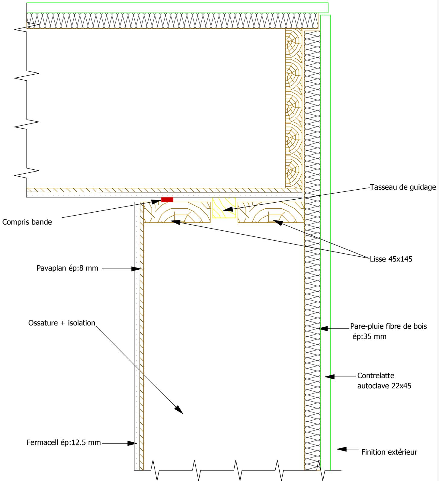
Détail de raccord de mur et caisson de toit
