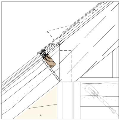
Les ardoises existantes sous gouttière recouvrent le profil stabilux H 50.
