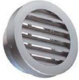
Les prises d'air et rejet d'air en façade seront réalisées par une grille extérieure circulaire. La grille de construction en aluminium anodisé est composée d'ailettes pare pluie espacées de 20mm, avec fixation non apparente par vis dans la collerette.
