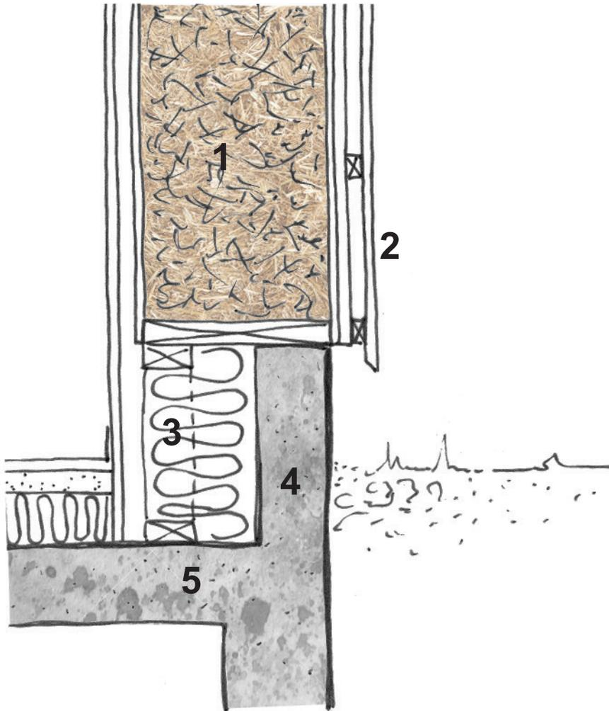
1. Isolation paille dans ossature bois - panneaux préfabriqués
