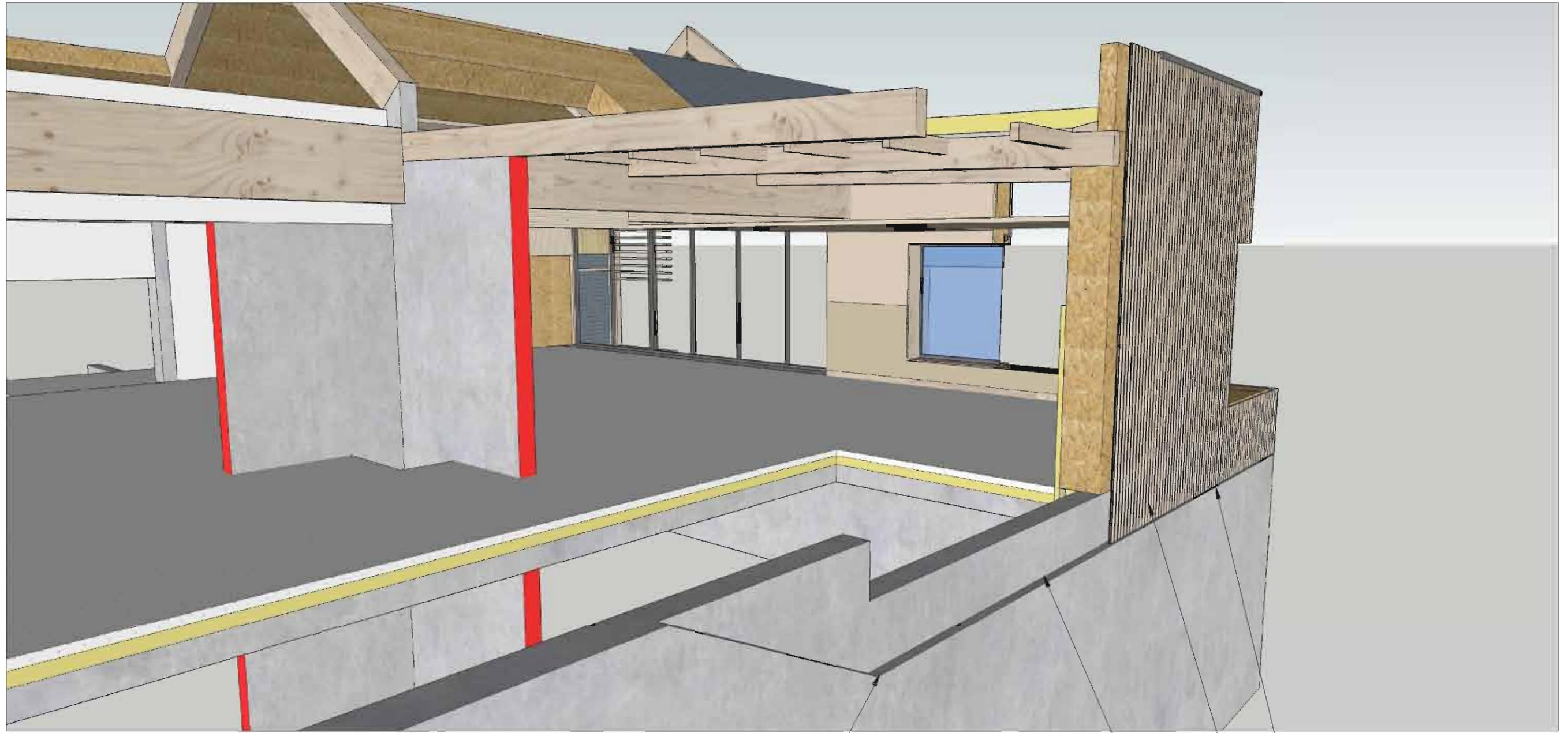
Profil spécifique du dégraisé pour suivre la variation altimétrique du pied de bardage bois
