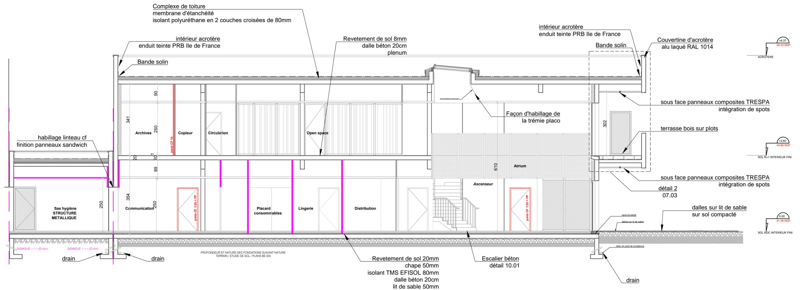
Toutes les cloisons (placo et cloisons modulaires) monteront jusque sous le plancher haut maçoné.
