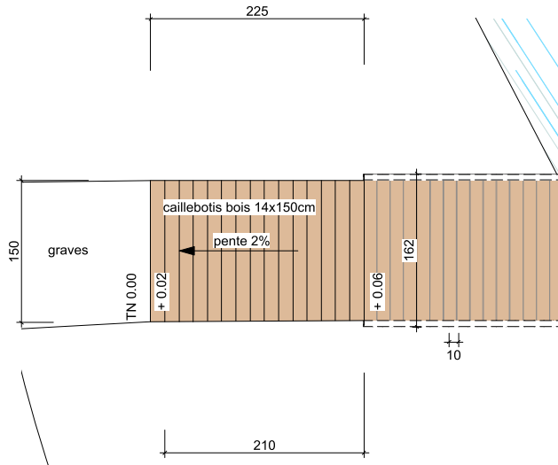
Plan de la passerelle 1.1 - 1/50
