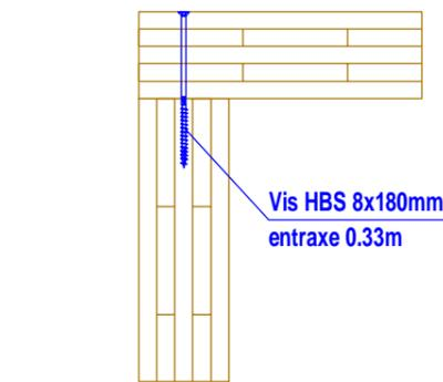
**Jonction plancher sur mur**
