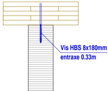
**Détail toiture sur poutre ou tête de mur**
