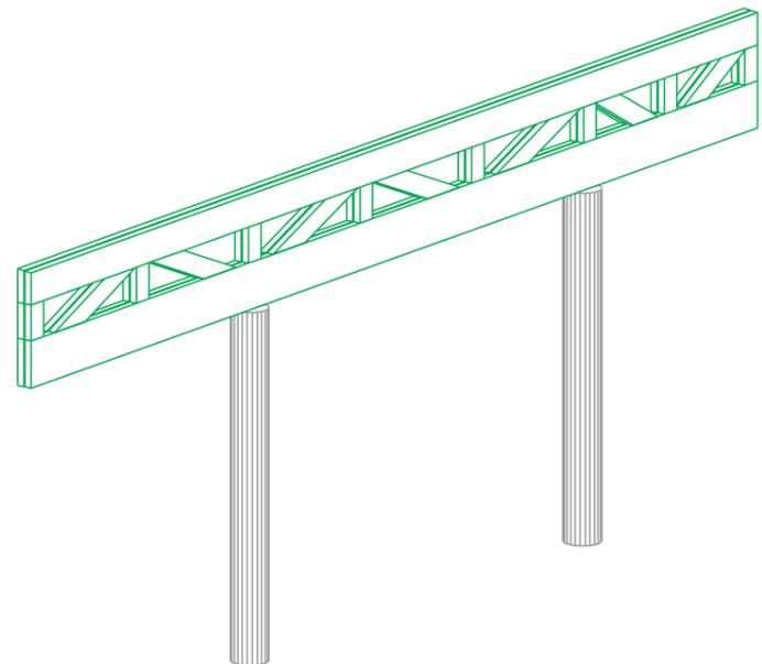
Axonométrie poutre treillis
