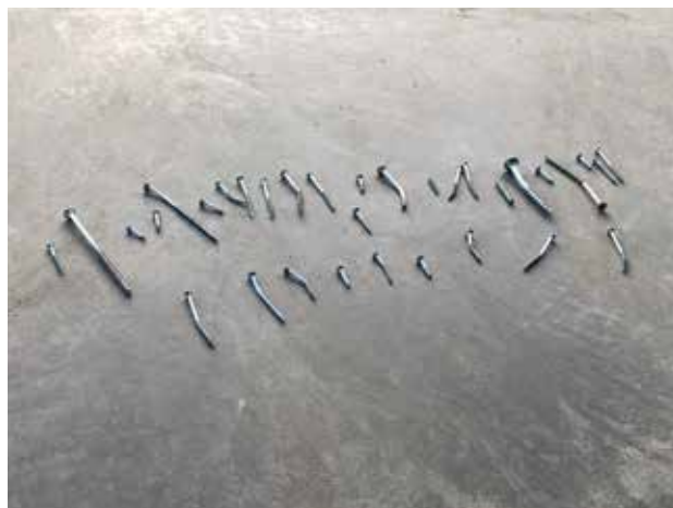
Bilan des éléments métalliques endommagés et non réutilisables
