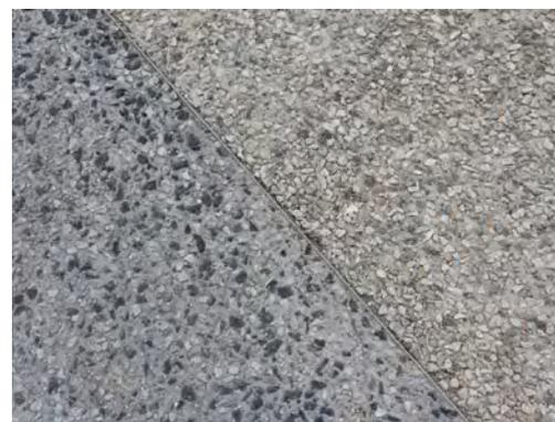
Béton désactivé granulat oisans sovemat avec ou sans pigment et basalte
