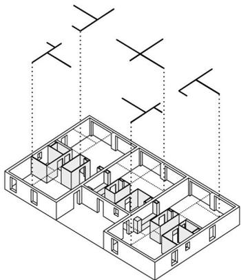
**3** un réseau de lisses en plafond forment support du cloisonnement et indiquent les partitions possibles du logement.
