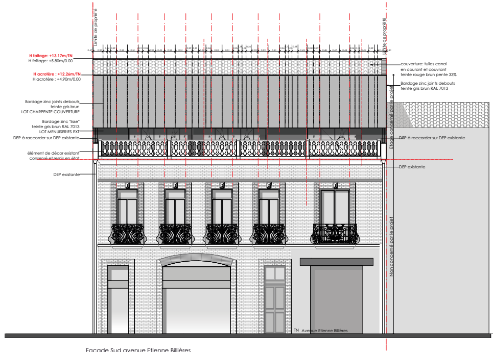
Façade Sud avenue Étienne Billières L'ensemble des menuiseries créées sera en aluminium teinte gris brun RAL 7013
