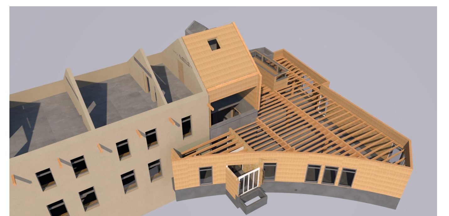
Vue sud-ouest de la structure bois
